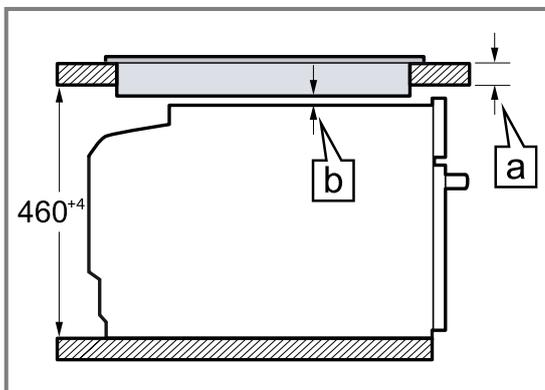
En raison de la distance minimale nécessaire **b** l'épaisseur minimale du plan de travail qui en découle est **a**.
