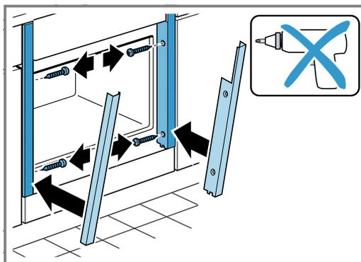
7. Si nécessaire, ajuster l'espace entre la porte de l'appareil et les caches latéraux en agissant sur la vis supérieure à gauche et à droite.
