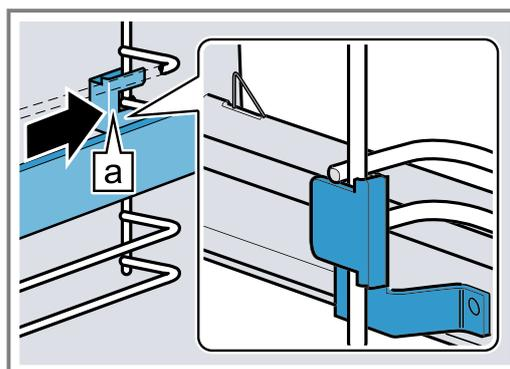
3. Maintenez **PUSH** enfoncé ① et faites pivoter le rail télescopique vers l'intérieur jusqu'à ce que la fixation [a] se trouve à l'avant entre les deux barres ②.
