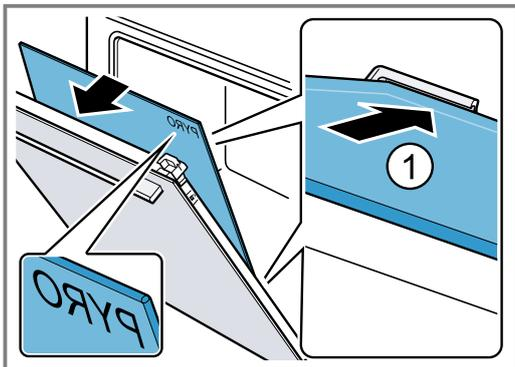
**5.** Appuyer sur la partie supérieure de la vitre intérieure ①. Poussez les capuchons coulissants [a] dans le sens de la flèche vers le bas.
