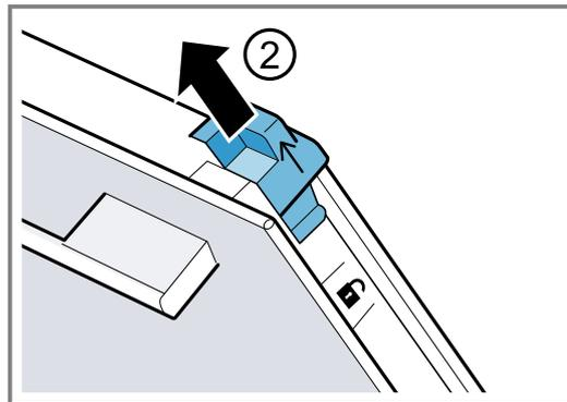
6. Retirez la vitre intérieure en diagonale vers le haut et déposez-la avec précaution sur une surface plane.
