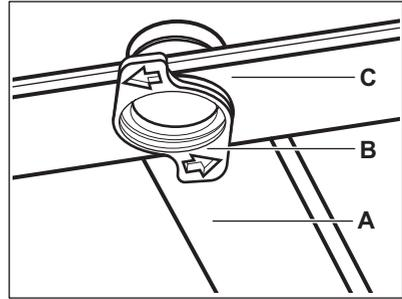
1. Lösen Sie die Anschläge auf den Seiten der Gleitschienen der Besteckschublade und ziehen Sie die Schublade heraus.
