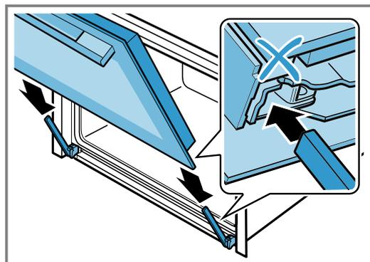
2. Appuyer sur le recouvrement de la porte avec les deux mains en haut à gauche et à droite pour vérifier si la porte de l'appareil est bien enfoncée jusqu'en butée.
