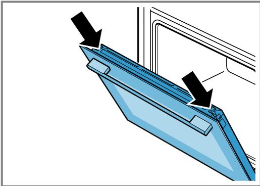
3. Ouvrez complètement la porte de l'appareil et poussez-la vers l'appareil.
