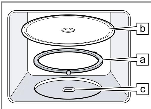
2. De draaischijf **b** in de aandrijving **c** in het midden van de bodem van de binnenuimte vergrendelen.
