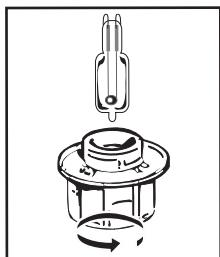
**È possibile sostituire autonomamente la lampada quando smette di funzionare.**
