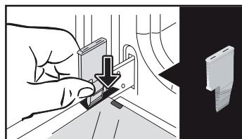
Entfernen Sie die erste mit Clip befestigte Scheibe: Drücken Sie mithilfe des anderen Keils (oder eines Schraubendrehers) gegen die Einbaupositionen **A**, um die mit Clip befestigte Scheibe zu entfernen.
