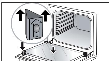
Sätt efter rengöring tillbaka de fyra gumibussningarna med pilen uppåt och sätt tillbaka samtliga glasrutor.
