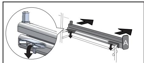
**N.B.: het uitschuifbare schuifgedeelte van de rail moet naar de voorkant van de oven uitgeklapt worden, het blokje
