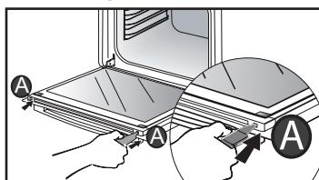
Entfernen Sie die Scheibe. Die Tür besteht aus zwei zusätzlichen Scheiben mit einem schwarzen Abstandsbolzen aus Gummi an jeder Ecke.
