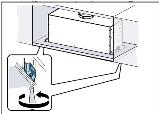
3. Vissez les deux vis avant et choisissez le perçage de manière à ce que la surface de l'appareil affleure le meuble d'encastrement.
