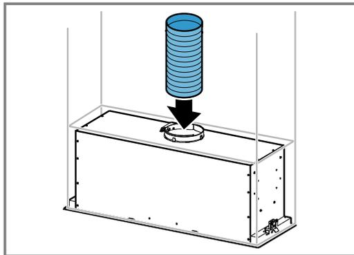
2. Réalisez la jonction vers l'orifice d'évacuation d'air.
