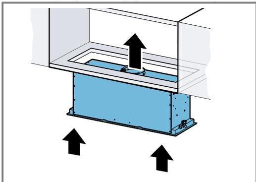
2. Vissez les deux vis de fixation en alternance à gauche et à droite. Utilisez un outil adapté afin de ne pas endommager la surface du cadre.
