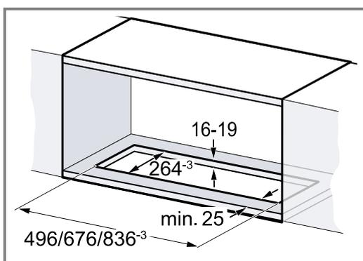
2. Réalisez la découpe pour le conduit d'évacuation soit au-dessus du meuble d'encastrement, soit derrière le meuble d'encastrement au-dessus de l'appareil.
