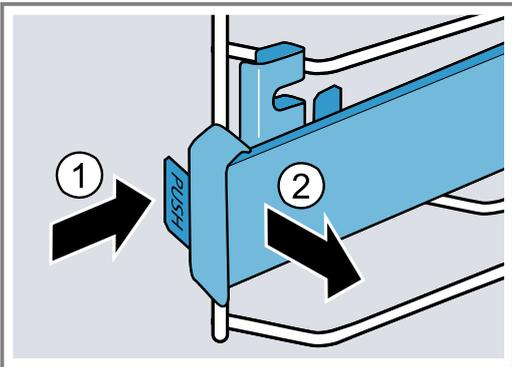
3. Tirez le rail vers l'avant jusqu'à ce que la fixation de derrière soit décrochée.
