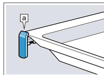
**Remarque :** Lorsqu'ils sont complètement sortis, les rails télescopiques s'enclenchent en place. Repoussez les rails télescopiques dans le compartiment de cuisson en exerçant une légère pression.
