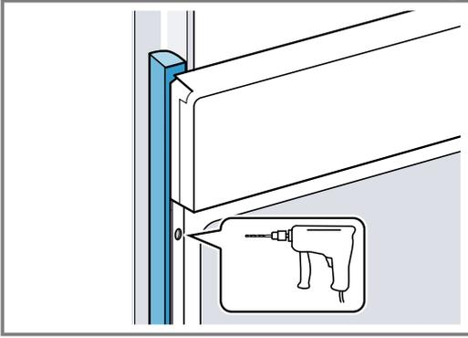
4. Fixez l'appareil avec une vis adéquate.
