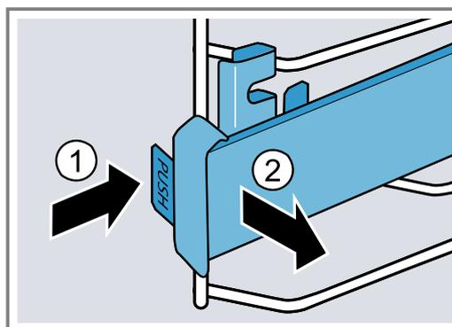
3. Tirez le rail vers l'avant jusqu'à ce que la fixation de derrière soit décrochée.
