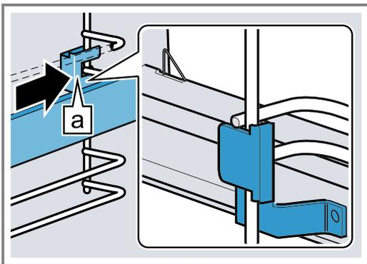
3. Maintenez **PUSH** enfoncé ① et faites pivoter le rail télescopique vers l'intérieur jusqu'à ce que la fixation [a] se trouve à l'avant entre les deux barres ②.
