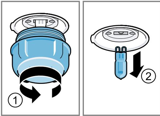
4. Insérez la nouvelle ampoule halogène et enfoncez-la fermement dans la douille. Veillez à la position des goupilles.
