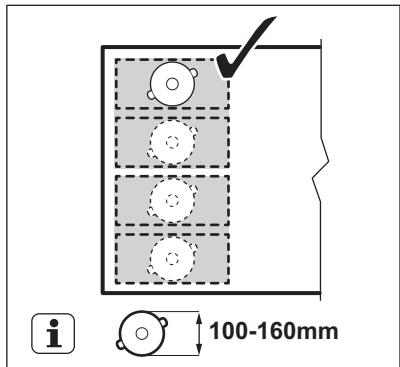
Se utilizar um tacho com diâmetro superior a 160 mm, coloque-o no centro entre duas secções.
