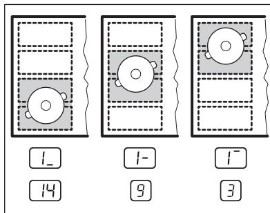
Pode alterar as definições de aquecimento para cada posição independentemente. A placa memoriza as suas definições de cozedura para a próxima vez que ativar a função.
