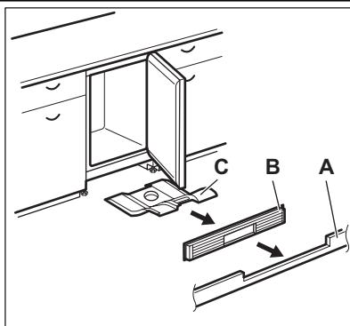
1. Entfernen Sie die Sockelleiste (A) und dann das Belüftungsgitter (B).
