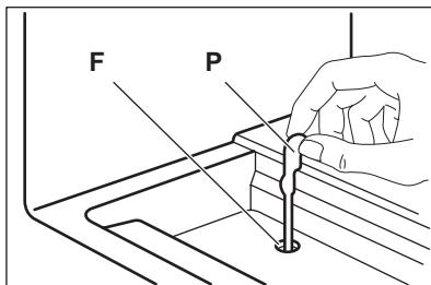
En fonctionnement normal, le givre est automatiquement éliminé de l'évaporateur du compartiment réfrigérateur à chaque fois que le compresseur s'arrête. L'eau de dégivrage est collectée dans un récipient spécial situé à l'arrière de l'appareil, au-dessus du compresseur, d'où elle s'évapore.
