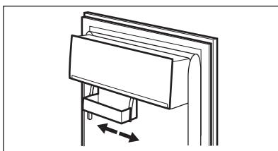
Das Modell ist mit einem variablen Lagerfach ausgerüstet, das unter einer Türablage festgelegt ist und sich seitlich verschieben lässt.
