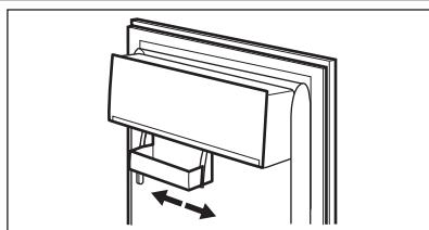
Le modèle est équipé d'un bac de rangement réglable, qui est fixé sous un balconnet de porte et qui peut glisser latéralement.
