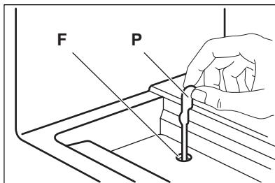
Bei normalem Betrieb wird Reif bei jedem Anhalten des Kompressors automatisch aus dem Verdampfer des Kühlschranks entfernt. Das Tauwasser läuft durch eine Rinne in einen speziellen Behälter an der Rückseite des Geräts über dem Motor-Kompressor, wo es verdampft.
