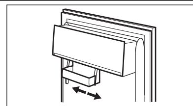
Den här modellen är utrustad med en flyttbar förvaringslåda som sitter under en hylla i dörren. Den kan flyttas i sidled. För en mer noggrann rengöring kan de övre och nedre dörrhyllorna enkelt demonteras och återmonteras
