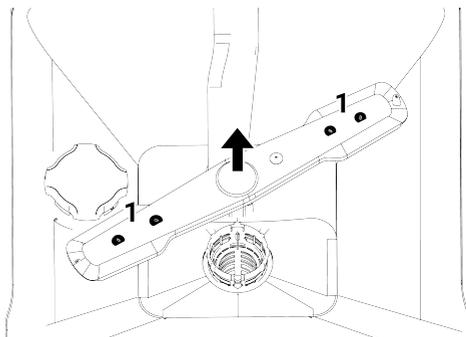
Vérifiez si les trous de l'ensemble turbine sont obstrués. En cas d'obstruction, retirez l'ensemble turbine et nettoyez-le. (Selon le modèle)
