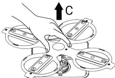
Pour démonter et nettoyer le groupe d'hélices inférieur, saisissez-le d'une main par les points (C) indiqués sur la figure et tirez-le vers le haut. Après le nettoyage, remettez le groupe d'hélices en place en suivant les mêmes étapes dans le sens inverse. (Selon le modèle)
