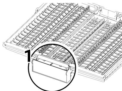
Dans les modèles à mouvement partiel, lorsque le bras (1) de la poignée est poussé, le plateau de la partie centrale du panier descend en position basse ; le système est déverrouillé et les plateaux latéraux droit et gauche peuvent être déplacés librement. Le déplacement des plateaux latéraux libère de l'espace et permet de charger les plats longs dans le panier supérieur.
