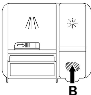
4. Augmentez le réglage en cas d'apparition de traces d'eau sur la vaisselle après le lavage, ou diminuez-le si une trace bleue subsiste après l'essuyage à la main. Le paramètre est réglé au niveau 3 depuis l'usine.
