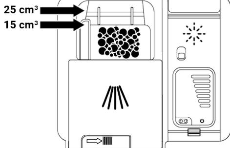
3. Fermez le couvercle du compartiment à détergent en le poussant dans le sens de la flèche. Un « clic » se fait entendre lorsque le couvercle est fermé.
