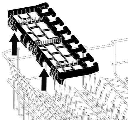
Vous pouvez facilement réinstaller la grille de service multifonction du panier supérieur sur le côté de votre panier supérieur pour l'utiliser à nouveau.
