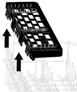
Vous pouvez facilement réinstaller la grille de service multifonction du panier supérieur sur le côté de votre panier supérieur pour l'utiliser à nouveau.
