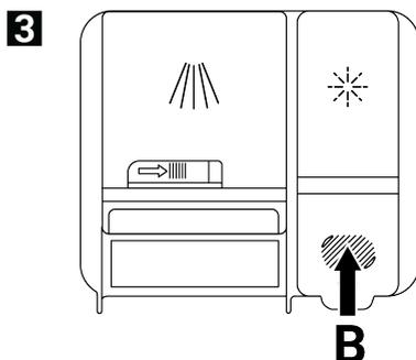
4. Augmentez le réglage en cas d'apparition de traces d'eau sur la vaisselle après le lavage, ou diminuez-le si une trace bleue subsiste après l'essuyage à la main. Le paramètre est réglé au niveau 3 depuis l'usine.
