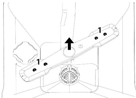
Vérifiez si les trous de l'ensemble turbine sont obstrués. En cas d'obstruction, retirez l'ensemble turbine et nettoyez-le. (Selon le modèle)
