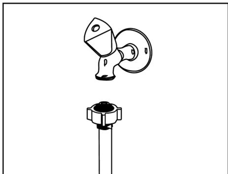
Il est déconseillé de raccorder le lave-vaisselle à des appareils à eau chaude ou à des chauffe-eau en marche.
