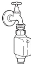
Tuyau d'arrivée d'eau sécurisé
