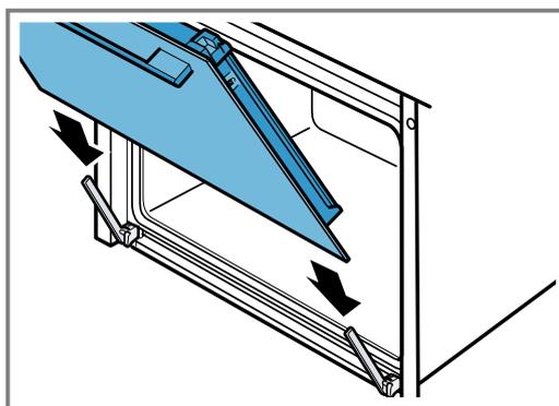
2. Poussez la porte de l'appareil jusqu'en butée à l'aide des deux mains.
