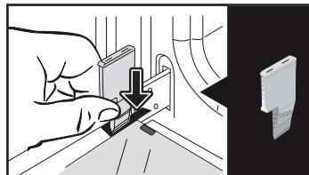
Verwijder de eerste vastgeklekte ruit: Druk met de andere wig (of een schroevendraaier) in de inkepingen A om de ruit los te klikken.
