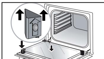
Tisztítás után helyezze vissza a négy gumiütközőt a nyílakkal felfelé, és helyezze vissza az ablakszerelvényt.
