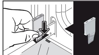
Entfernen Sie die erste mit Clip befestigte Scheibe: Drücken Sie mithilfe des anderen Keils (oder eines Schraubendrehers) gegen die Einbaupositionen **A**, um die mit Clip befestigte Scheibe zu entfernen.
