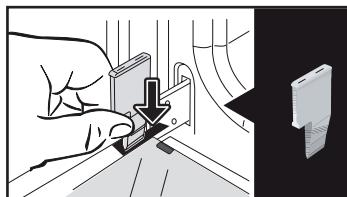
Extraiga el primer cristal enganchado: Con la ayuda de otra cuña (o de un destornillador) presione en las ranuras **A** para desenganchar el cristal.
