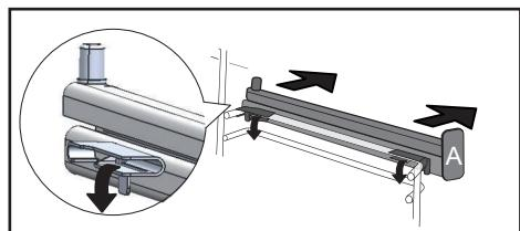
**N.B.: het uitschuifbare schuifgedeelte van de rail moet naar de voorkant van de oven uitgeklapt worden, het blokje
