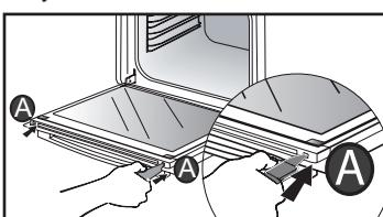
Снимите стекло. Дверца состоит из двух дополнительных стекол, на каждом углу которых находится по черной резиновой соединительной стойке.
