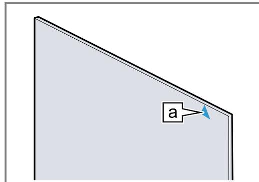
2. Introduire la vitre intermédiaire en bas dans la fixation [a] ① puis appuyer sur le haut en maintenant la pression.
