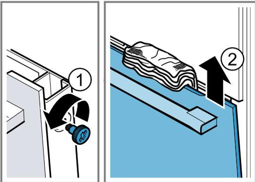
7. Extraire la vitre frontale par en haut et la déposer sur une surface plane, la poignée de porte orientée vers le bas.
