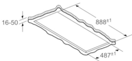
Ne pas monter directement sur un faux plafond constitué de plaques de plâtre ou d'un matériau de construction léger similaire. Il est impératif d'utiliser un support adapté et solidement fixé dans la dalle en béton.
