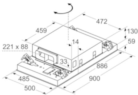
La sortie du ventilateur peut être tournée dans les quatre directions
