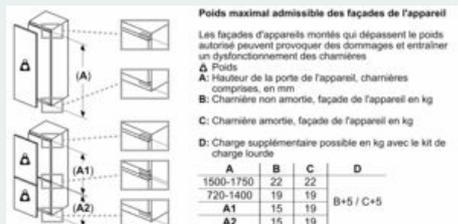
Poids maximal admissible des façades de l'appareil
