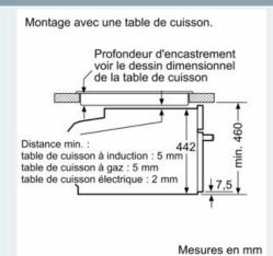
Si l'appareil compact est installé sous une table de cuisson, les épaisseurs de plaque de travail suivantes (le cas échéant y compris la sous-structure) doivent être respectées.
