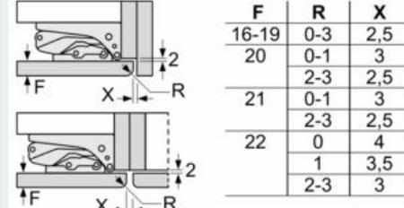
Les dimensions d'espace libre recommandées dans le tableau doivent être respectées afin d'assurer une ouverture sans collision des portes de l'appareil, et d'éviter ainsi d'endommager les meubles de cuisine.
