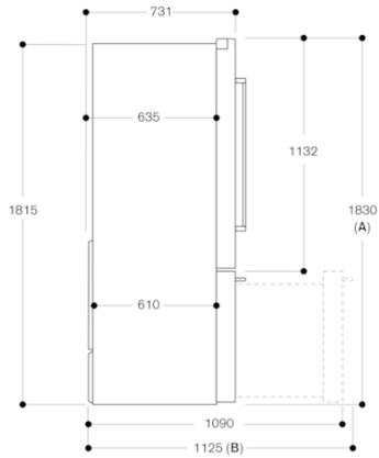
**A:** La dimension de la façade est ajustable de 1830 jusqu'à 1847 lorsque les pieds de nivellement avant sont entièrement sortis
