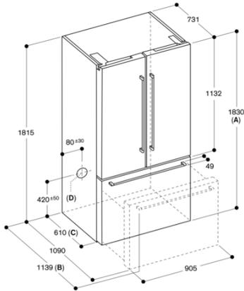
A : La dimension de la façade est ajustable de 1830 jusqu'à 1847 lorsque les pieds de nivellement avant sont entièrement sortis.
