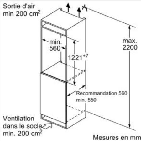
Ventilation dans le socle min. 200 cm<sup>2</sup>
